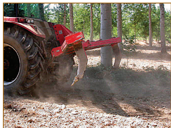
Photo 8. Des travaux de recherche ont démontré que le cernage racinaire (p. ex., à l'aide d'une sous-soleuse) peut limiter la compétition souterraine entre les arbres et les cultures.
